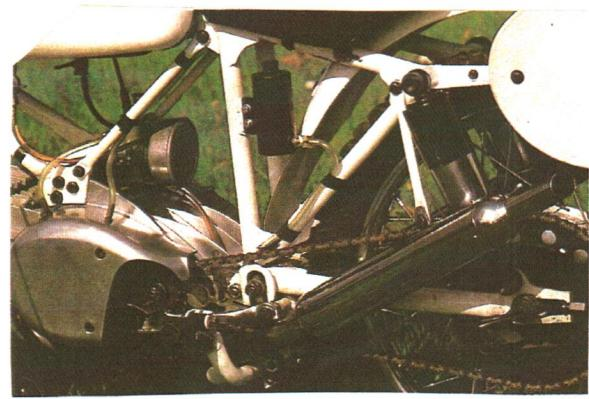
le petit réservoir d'huile pour le graissage de la chaîne
